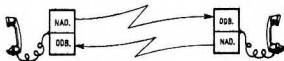
Rys. 3. Dwa zestawy nadawczo-odbiorcze (uzupełnione elementami aparatu telefonicznego) umożliwiają prowadzenie dwustronnej rozmowy „bez drutu”
